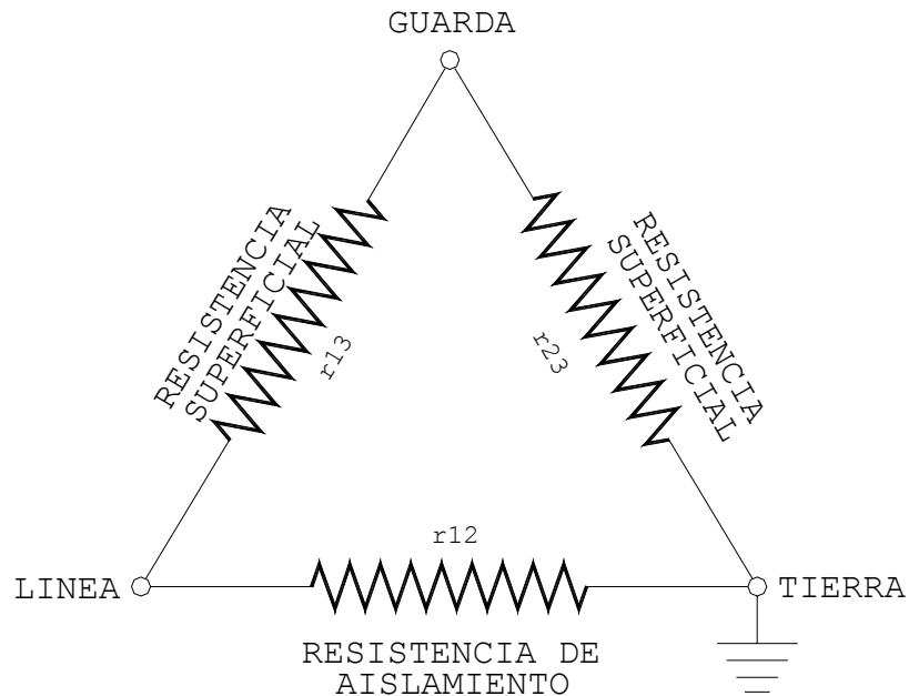
FIG. 2.4 DIAGRAMA DE RESISTENCIAS LINEA - GUARDA -TIERRA
